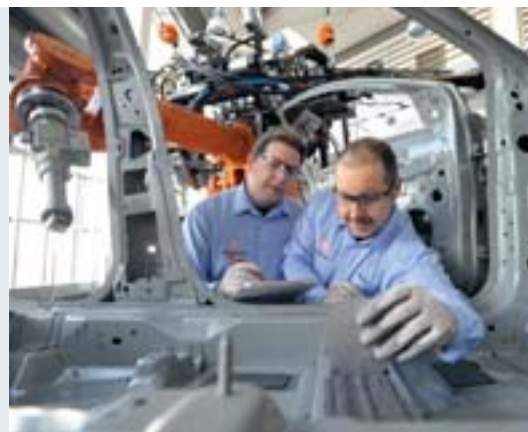
Die Anwendungstechniker Mario Werner (links) und Harald Nees haben mithilfe eines robotergeführten Applikationssystems eine schalldämmende Beschichtung in eine Karosserie aufgetragen. Jetzt prüft Harald Nees die Schichtdicke.
